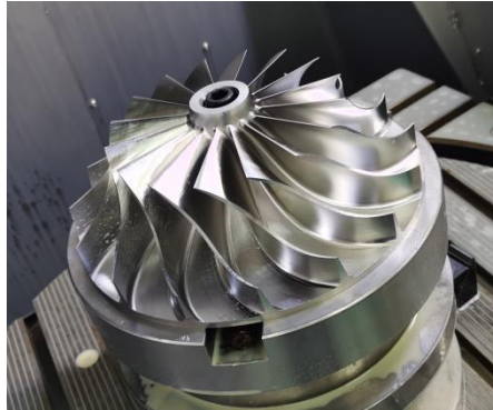
图7 离心叶轮加工用夹具
